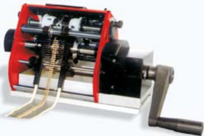
La machine SUPERFORM/AF coupe, plie et forme les pattes des composants axiaux.
