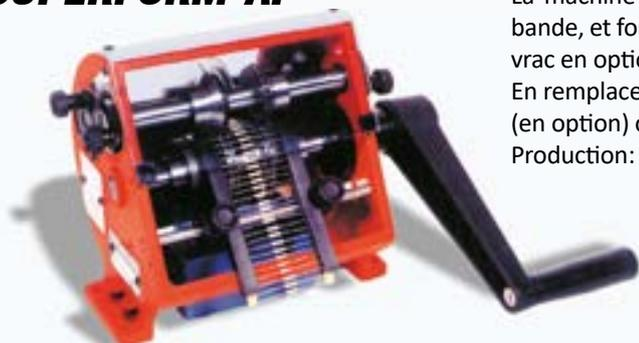
La machine SUPERFORM/AP coupe et plie les pattes des composants axiaux en bande, et forme en plus une boucle sur chaque patte. Motorisation et alimentateur vrac en option. On peut former des pattes d'un diamètre 1mm mini à 1,4mm maxi. En remplaçant les deux roues coupe/forme avec "deux roues de coupe seulement" (en option) on peut obtenir une forme U sans boucle. Production: jusqu'à 20000 pièces/heure.
