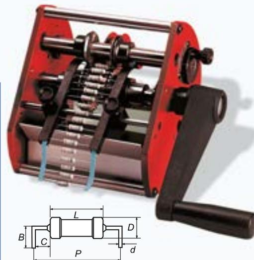
La machine SUPERFORM/V-LC coupe et plie les pattes des composants axiaux en bande pour montage vertical.
