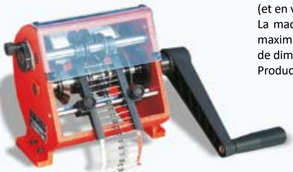
La machine SUPERFORM/A coupe et plie les pattes des composants axiaux en bande (et en vrac avec l'option alimentateur vrac). Motorisation en option (voir page 10). La machine est solide et compacte : elle peut admettre des pattes de diamètre maximum 1,3mm, voire 1,4mm en variante. Les réglages permettant de changer de dimensions de formage ou de coupe sont rapides et simples. Production: jusqu'à 40000 pièces/heure
