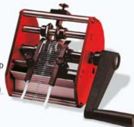
La machine SUPERFORM/R-LC coupe les pattes des composants radiaux en bande.
